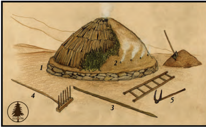
X. La carbonaia: calzòlo (1), banchina (2), forcone (3), rastiello (4) e bidente (5). Disegno dell'autore.
