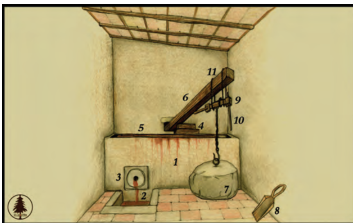
V. Palmento (1), tina (2), bocchetta (3), tròppoli (4), premitóia (5), travetta (6), sassileva (7), sàssera (8), arganello (9), stanghe (10) e brache (11). Disegno dell'autore.
